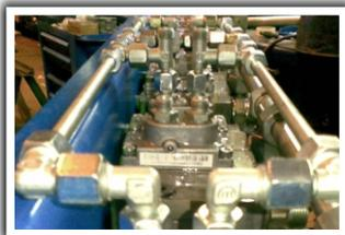
Гидравлические распределители с предохранительными клапанами.
