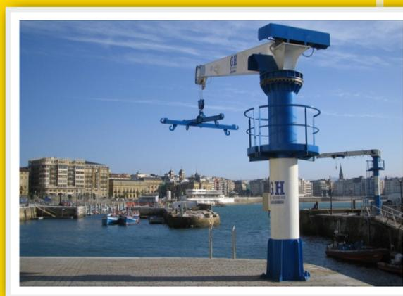
Стандартизация механизмов посредством применения простых модульных конструкций позволяет производить широкий ассортимент кранов с поворотной стрелой грузоподъемностью от 4 до 20 тонн с длиной стрелы до 7 м. Общей характеристикой для таких кранов является простота в использовании и маневрировании.
