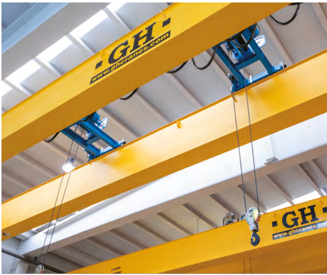
PONT ROULANT AVEC DEUX PALANS
